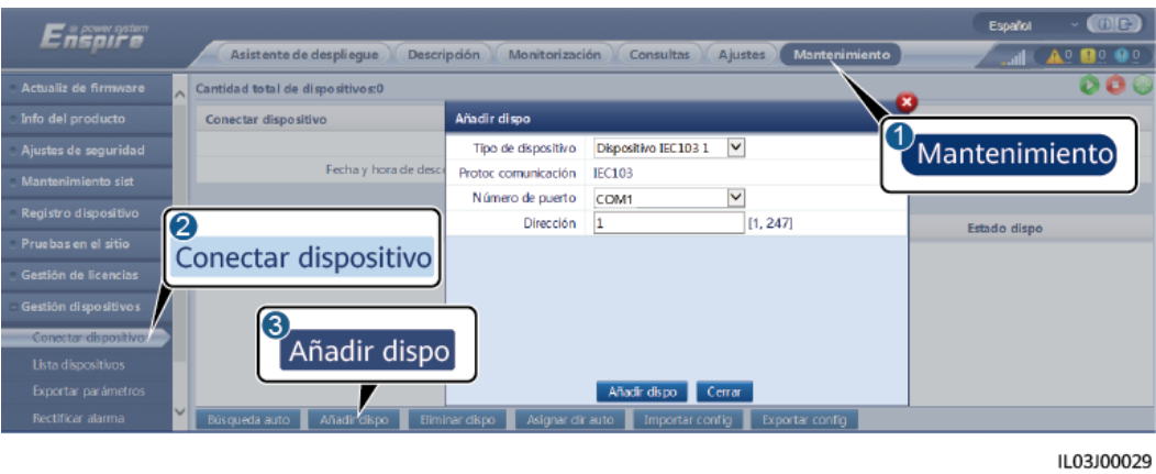
Figura 6-61 Configuración de los parámetros de acceso
