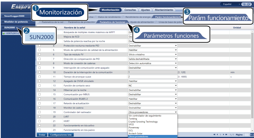
Figura 6-48 Configuración del controlador del sistema de seguimiento
