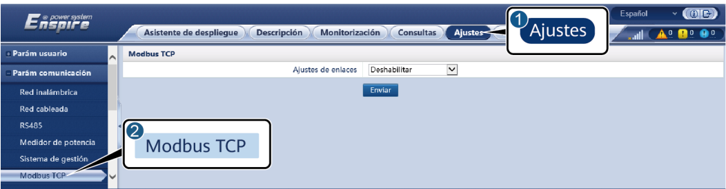
Figura 6-32 Configuración de los parámetros de Modbus TCP
