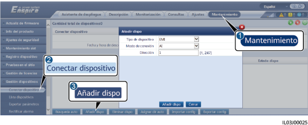
Figura 6-55 Configuración de los parámetros de acceso
