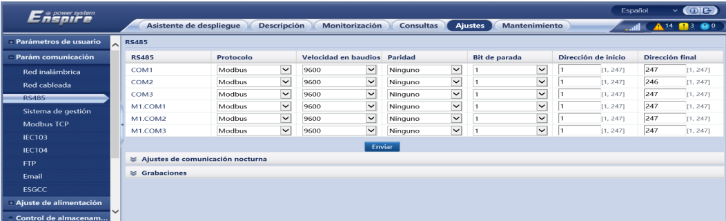
Figura 6-38 Configuración de los parámetros de RS485
