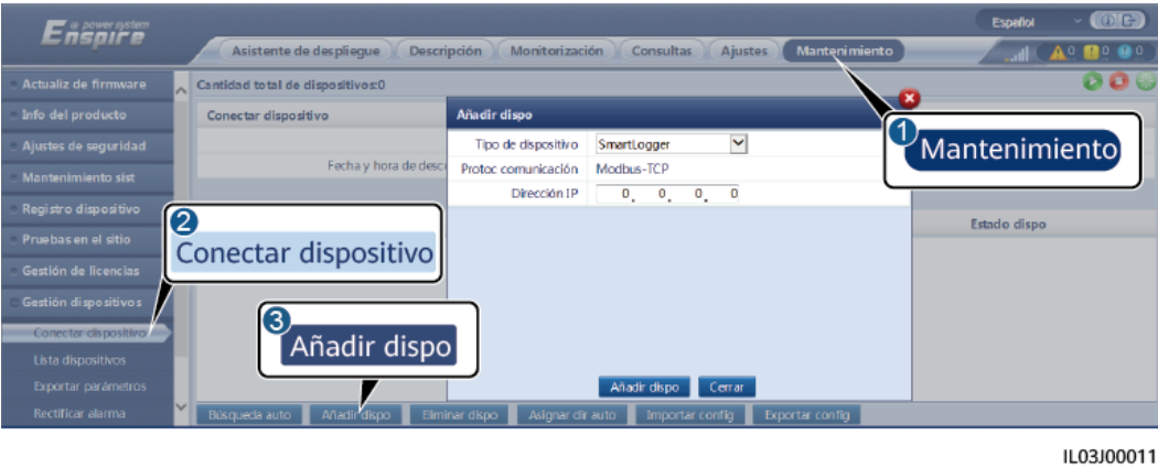
Figura 6-40 Configuración de los parámetros de acceso
