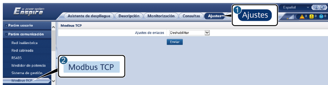
Figura 6-36 Configuración de los parámetros de Modbus TCP
