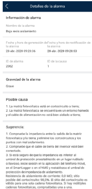
Figura E-1 Detalles de alarma
