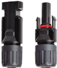
MC4 son conectores eléctricos de un solo contacto utilizados para conectar módulos fotovoltaicos. Las siglas MC4 significan multi.contact y un 4 para el pin de contacto de 4mm de diámetro.
